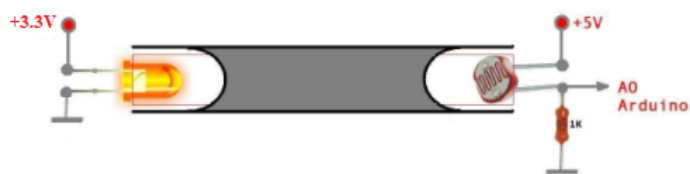
Рисунок 3.3 - Оптический датчик изгиба на основе силиконовой трубки
